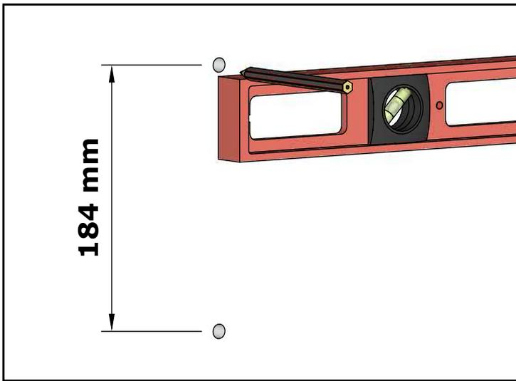
С помощью линейки и строительного уровня размечаем отверстия для крепления на стене. Расположение отверстий на стене и полке должны строго совпадать
