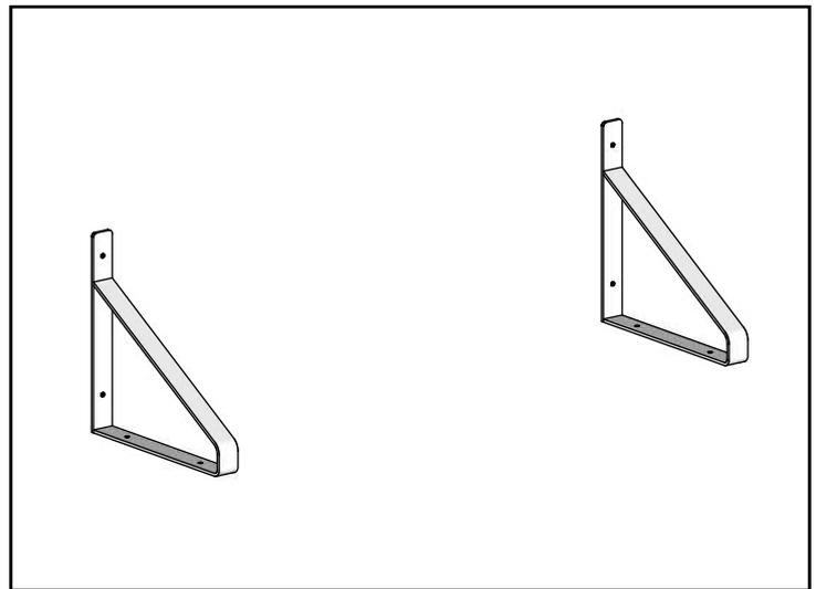
Шурупами закрепляем кронштейны на стене. Вкручиваем шурупы отверткой
