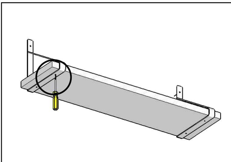
Крепим полку к металлическим кронштейнам при помощи саморезов
