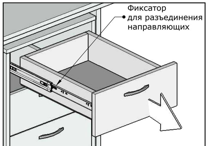
Выдвигаем ящик чтобы проверить зафиксирован ли он
