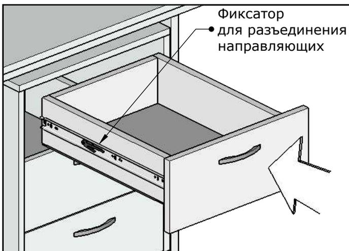
Устанавливаем ящики на направляющие до характерного щелчка.
