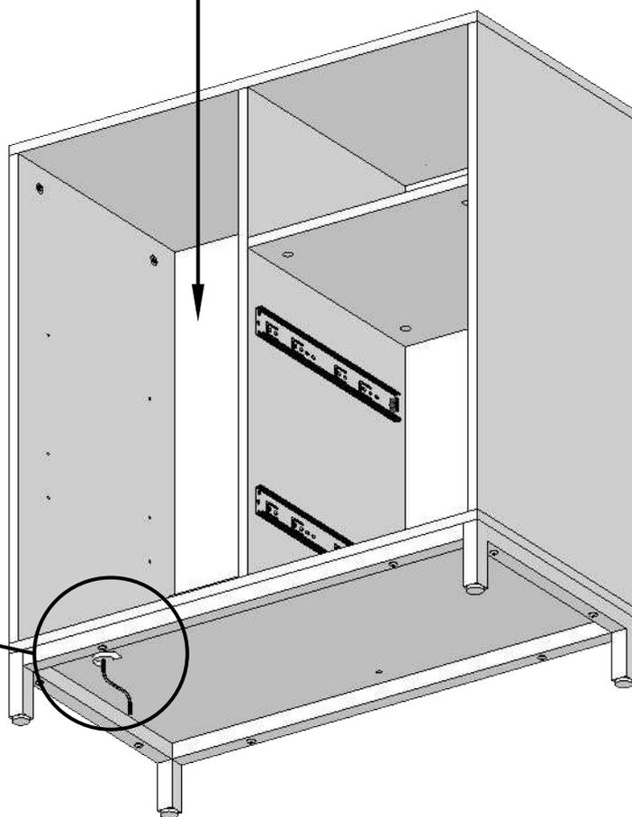
Вставляем полкодержатели в отверстия на боковинах тумбы и устанавливаем
